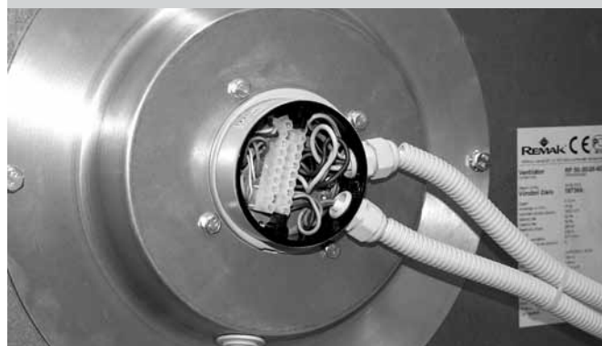
Рис. 12 - пластмас. клеммная коробка на статоре
