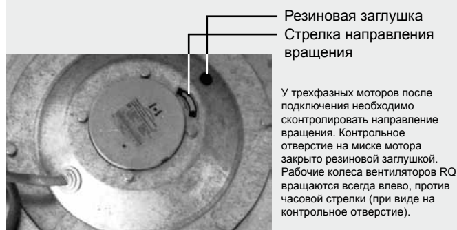
Рис. 6 - резиновая пробка контрольного отверстия
