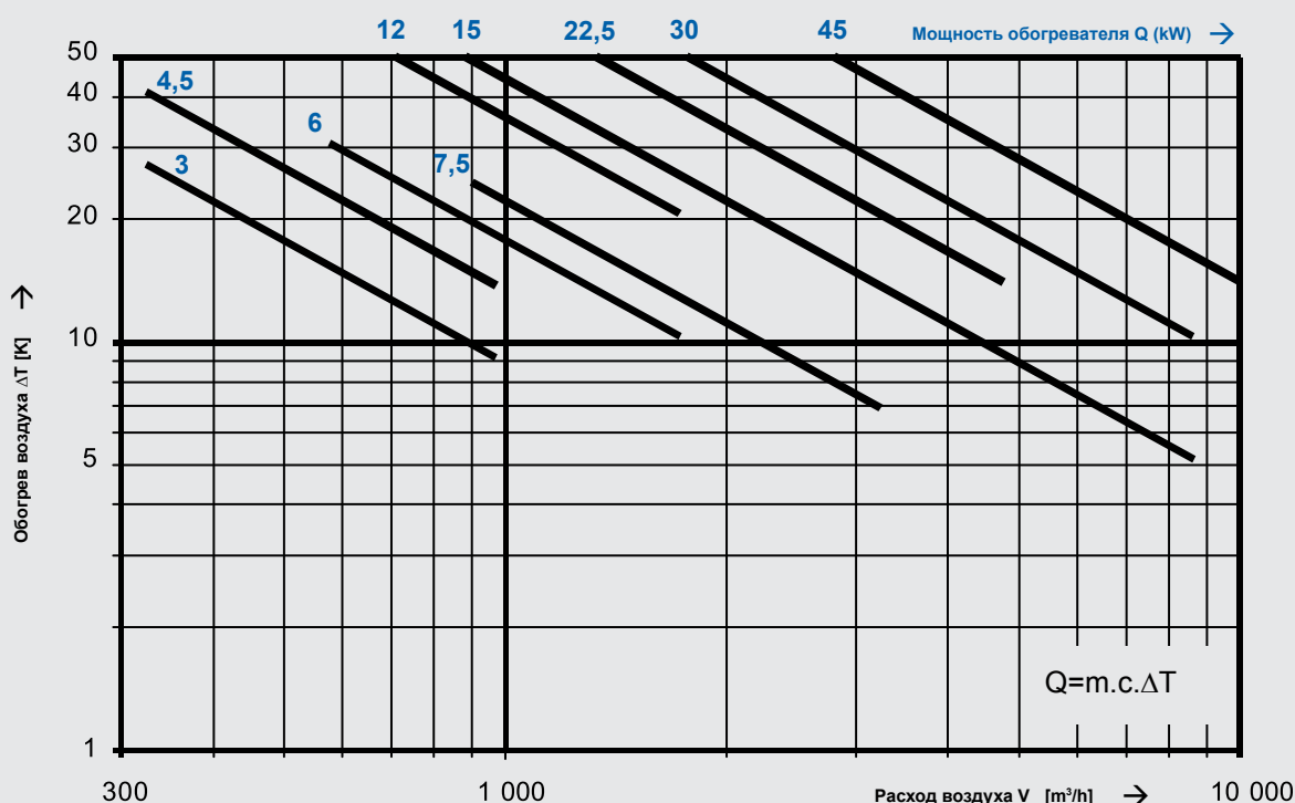
Рис. 4 – увеличение температуры воздуха на обогревателе в зависимости от расхода
