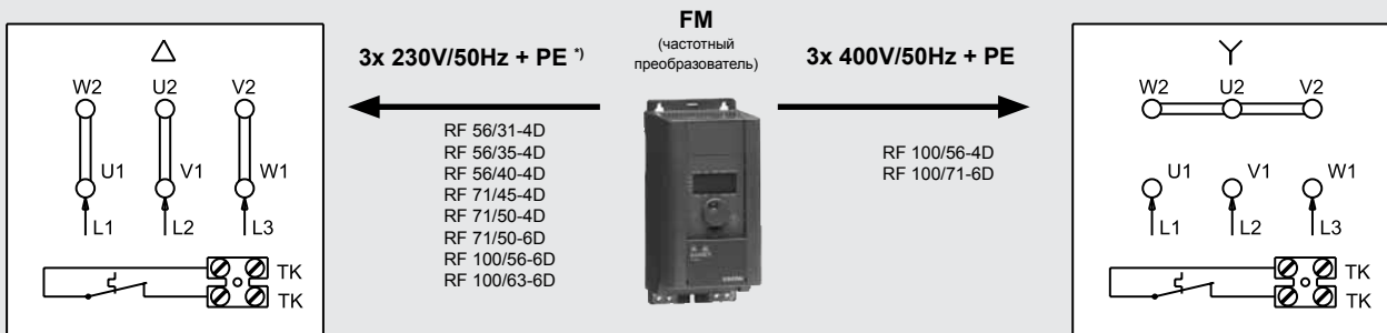
Рисунок 4 – включение Y/Δ на клеммнике трехфазного двигателя
