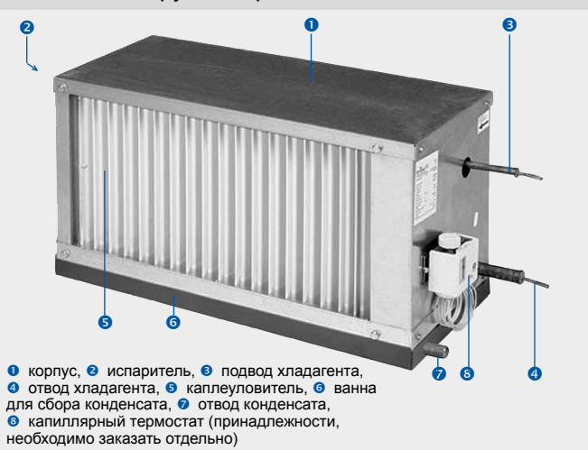
Рис. 1 - конструкция прямого охладителя
