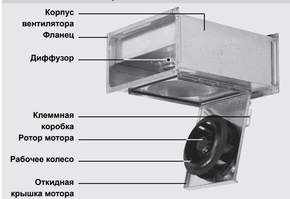
Рис. 3 - состав вентилятора RO
