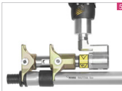
Установить запрессовочные тиски
