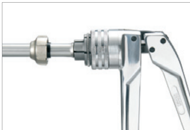
Рис. 15-7 Произвести развальцовку присоединительной трубки
