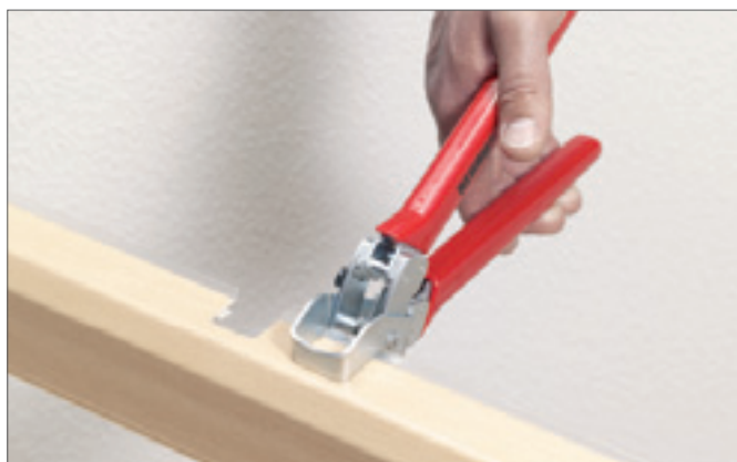
Рис. 18-40 Вырезка прямоугольных отверстий в крышке плинтусных каналов
