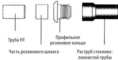
**Соединение с чугунной трубой SML**
