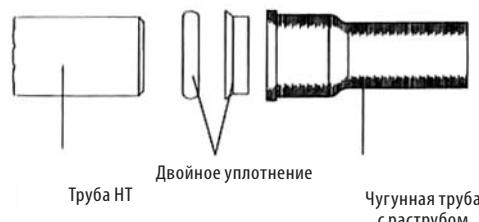
Соединение с растробом стальной трубы
