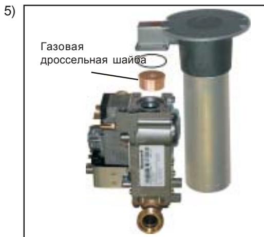
5) Вытащить газовую дроссельную шайбу и заменить ее на дроссельную шайбу, предназначенную для сжиженного газа.
