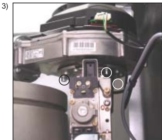
3) Отсоединить смешивательную камеру от вентилятора (отвинтив 3 винта с шестигранной головкой 5 мм), в случае необходимости отсоединить воздухозаборный патрубок
