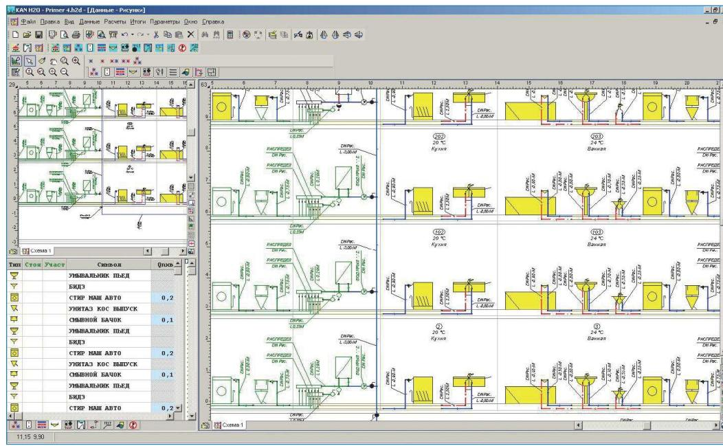
Рис. 89 Схема системы водоснабжения в программе **KAN H2O**
