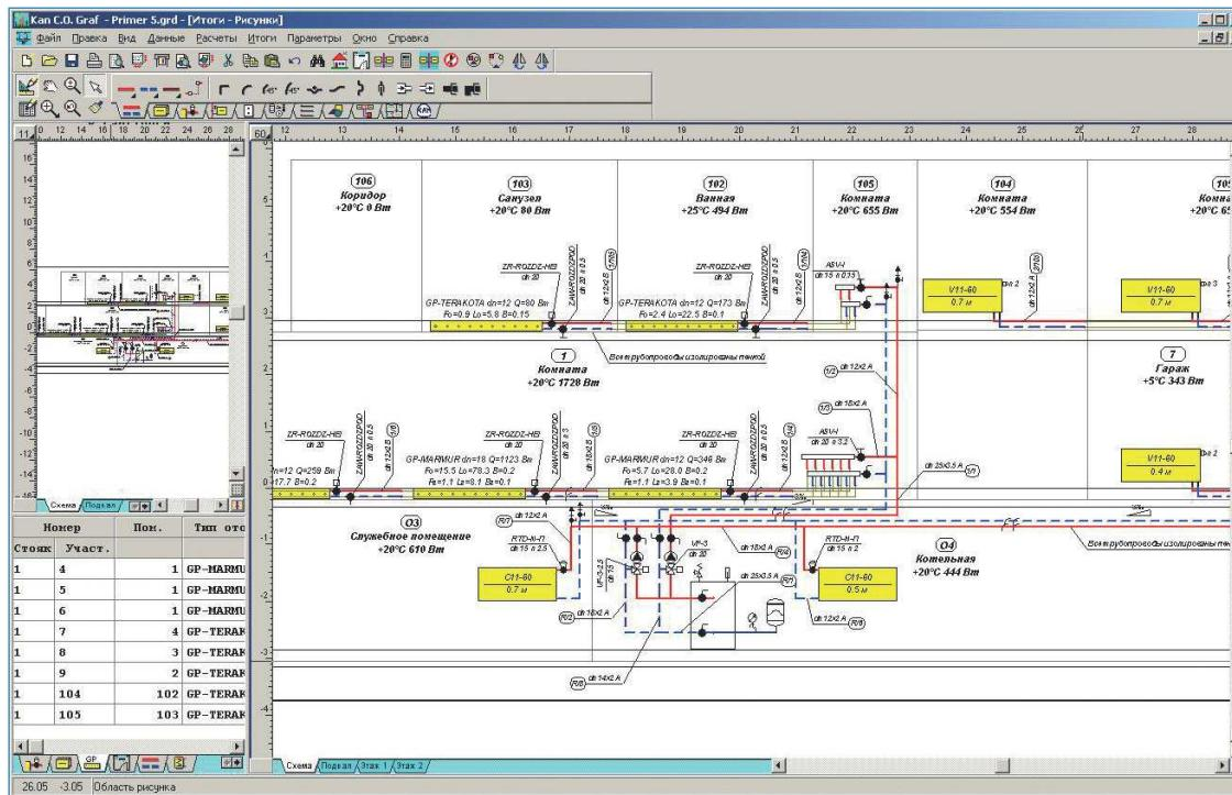
Рис. 88 Схема отопления в программе **KAN co-Graf**
