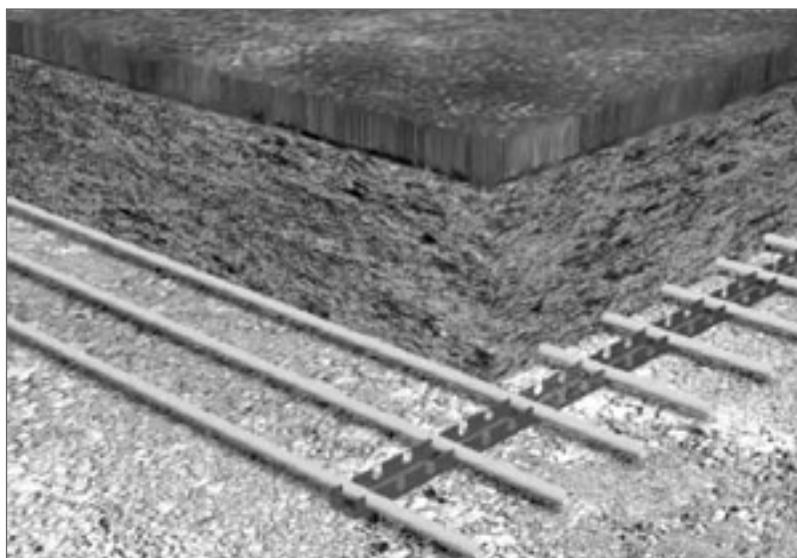
Рис. 2. Подогрев поверхности стадиона с травяным покрытием.
