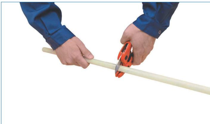
1. Трубу PE-Xc, PE-RT, PE-Xc/Al/PE-HD отрезать перпендикулярно к оси на требуемую длину с помощью ножниц для полиэтиленовых труб. Не допускается использование другого инструмента или неисправных ножниц (тупых или выщербленных).
