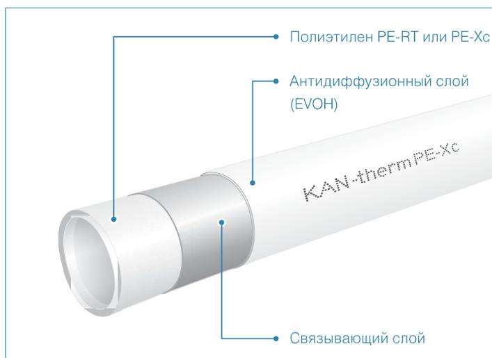
Рис. 1 Конструкция трубы PE-RT (PE-Xc) с антидиффузионным покрытием
