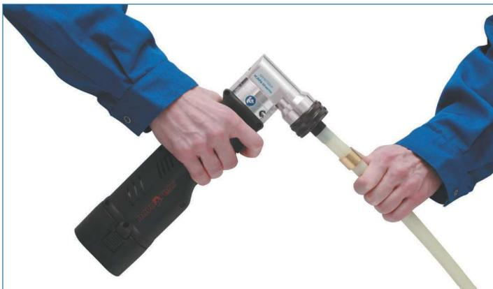
3. Аккумуляторный или ручной расширитель оснастить головками, соответствующими типу и диаметру трубы. Выполнить раскалибровку (расширение) трубы с помощью расширителя за три цикла. Первые два - неполные, при этом проворачивая расширитель относительно трубы на 20°. Третий цикл - полный.
