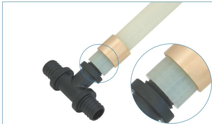
4. Тотчас (!) после раскалибровки вставить фасонное изделие в трубу до последнего углубления на его штуцере (не тянуть трубу к фланцу фасонного изделия!). Не использовать средства для улучшения скольжения трубы!
