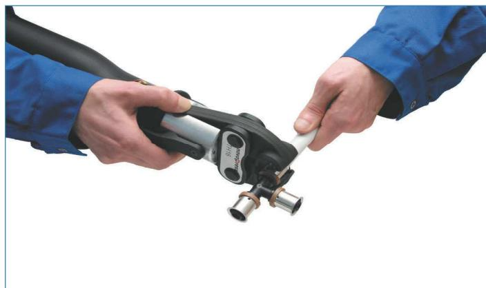
6. Разблокировать пресс-клещи и снять их с обжатого кольца. Соединение готово для испытаний давлением.
