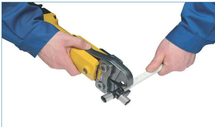
7. Разблокировать пресс-клещи и снять их с обжатого кольца.
