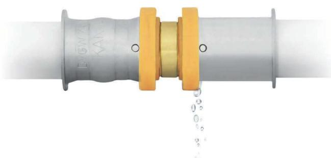
LBP – „Leak Before Press” - утечка в местах неопрессованных соединений. Ошибочно неопрессованное соединение сигнализирует утечкой уже во время заполнения водой смонтированной системы, еще до испытаний давлением. Эта функция соответствует предписаниям DVGW („контролируемая утечка”).
