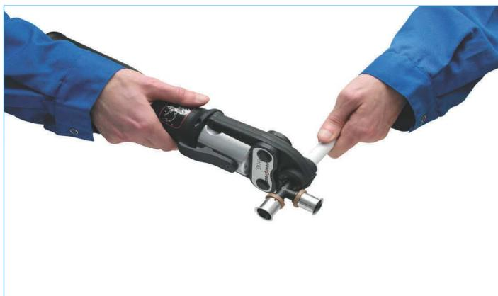
5. Запустить пресс и выполнить соединение. Процесс опрессовки (обжима) длится до момента полного смыкания клещей пресса. Опрессовка кольца на трубе может выполняться только один раз.
