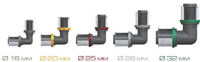
Каждый соединитель KAN-therm Press LBP имеет специальное пластмассовое кольцо, цвет которого зависит от диаметра соединяемых труб. Такое решение облегчает идентификацию соединителя, что в свою очередь ускоряет процесс монтажа и складирования этих элементов. Независимо от идентификации по цвету, на корпусе соединителя рядом со штуцером проштампованы соответствующие диаметры. Размеры присоединяемых труб (наружный диаметр × толщина стенки) также указаны на стальных пресс-кольцах.
