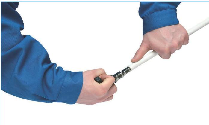
3. Раскалировать трубу и снять фаску с ее внутреннего края калибратором. Слой алюминия не должен быть нарушен. Края трубы должны быть ровными и без заусениц.
