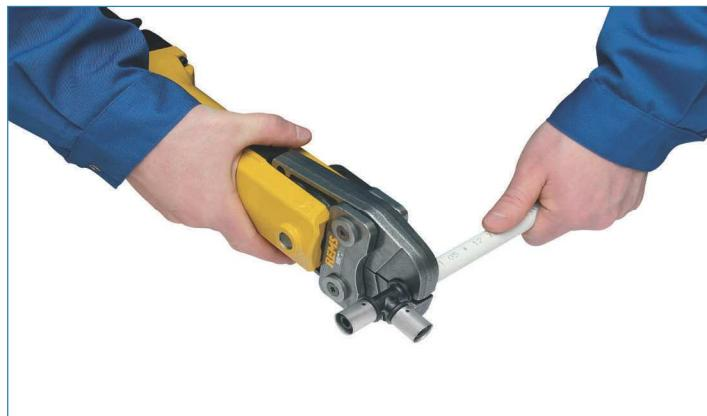
6. Запустить пресс и выполнить соединение. Процесс опрессовки (обжима) длится до момента полного смыкания клещей пресса. Опрессовка кольца на трубе может выполняться только один раз.
