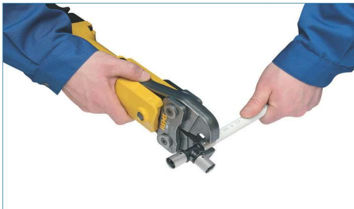
5. Клещи пресса расположить на кольце перпендикулярно оси трубы так, чтобы они соприкасались с фланцем соединителя. Пресс-клещи не должны обхватывать фланец.
