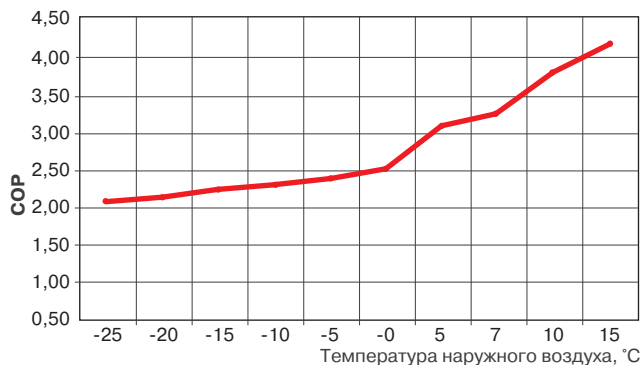
График изменения COP в зависимости от уличной температуры (при поддержании в помещении температуры 20 °C)
