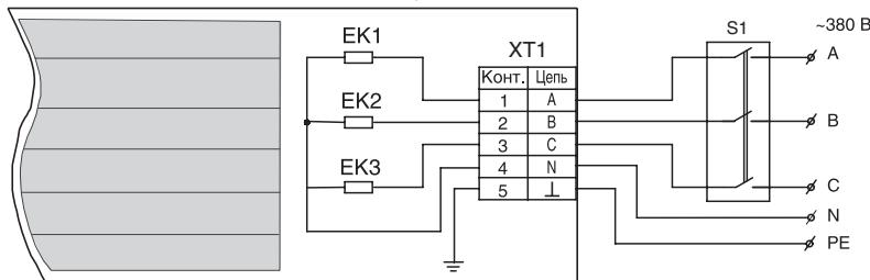
Рис. 3. Обогреватель BIH-3.0; BIH-4.0
